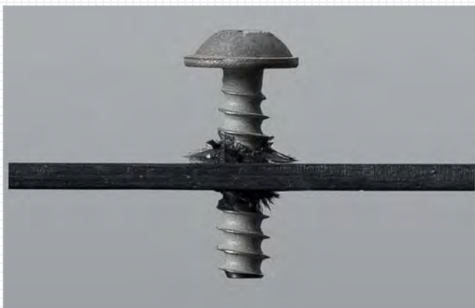
Durch Delamination zerstörtes CFK-Bauteil
