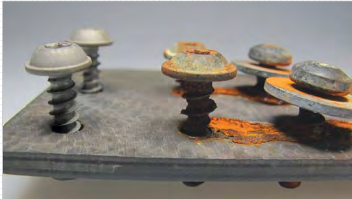
Vergleich b&m-CARBONPLAST® (li) zu marktüblichen Stahlschrauben mit Zn/Ni-Beschichtung (re) im Salzsprühnebeltest nach 480h
