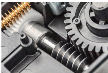
Anwendungsbeispiel der Burger Group: Für diesen Aktuator liefert Baier & Michels die spanlos gefertigte Schneckenwelle – in hoher Oberflächenqualität und damit sofort einbaufertig.
