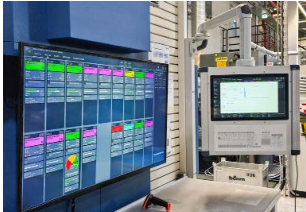
Status im Blick: Die Maschinenübersicht informiert jederzeit vollumfänglich über den Stand der Fertigung – ob Taktzeiten, Maschinenstillstände oder Fehlerquote. © b&m/Andreas Wollny
