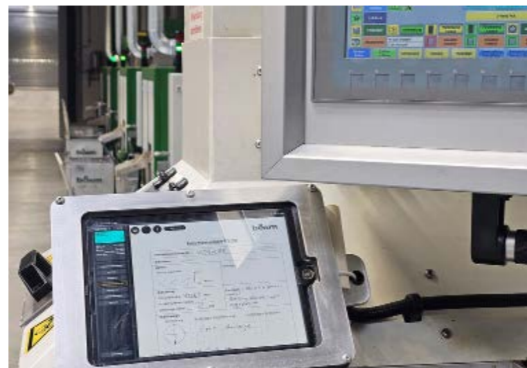
Auftragsinformationen direkt an der Maschine: Das Cockpit bietet eine Einsicht in Aspekte wie Produktionszeichnungen, Stücklisten und Werkzeugpläne. © b&m/Andreas Wollny
