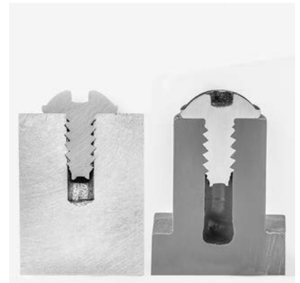
Permite conseguir una elevada cobertura de los flancos en uniones atornilladas de aleaciones de metales ligeros y plásticos
