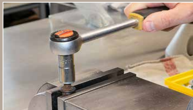
Beim Andrehen spürt man im Wechsel einen Widerstand, der sich dann beim Herausfordern der Späne wieder löst. Fotos: Bertling
