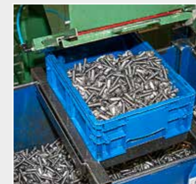
Die fertigen Schrauben werden in der Waschanlage vom Schmiermittel befreit und im Anschluss noch einmal vergütet.
