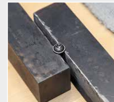
Ausgebaut lässt sich am besten erkennen, wie die Walzwerkzeuge für das Gewinde funktionieren: Eine Walzbacke ist fest angebracht, die andere rollt die Schraube durch die Formen.
