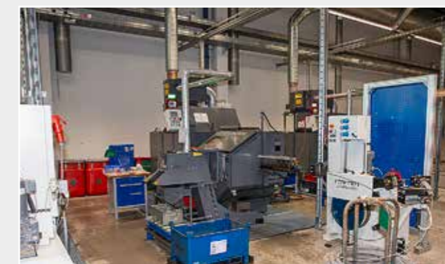
Diese Maschine richtet den Drahtcoil, längt die passenden Abschnitte ab und presst in mehreren Stufen den fertigen Schraubenrohling.
